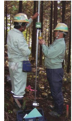
SH型貫入試験
