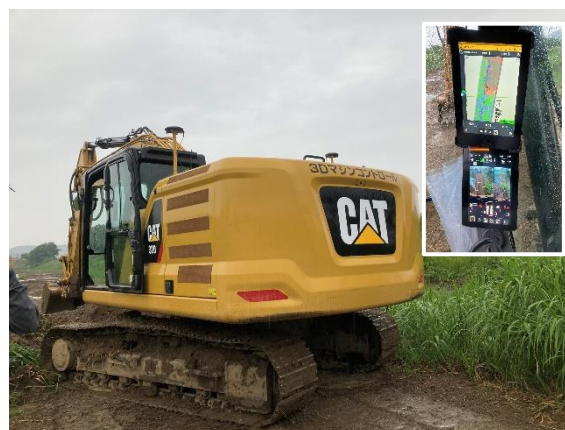
ICT 建機（右上は操縦席のオペレーションシステム）
