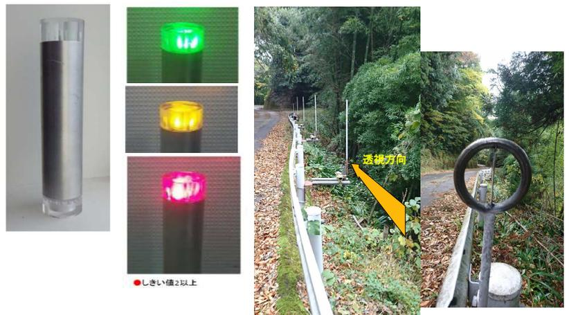
傾斜度を光で示す「傾斜計」
