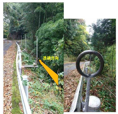
傾斜度を光で示す「傾斜計」
